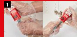
Handschuhe anziehen und wiederverschließbaren Deckel öffnen. Mischdüse aufdrehen.
