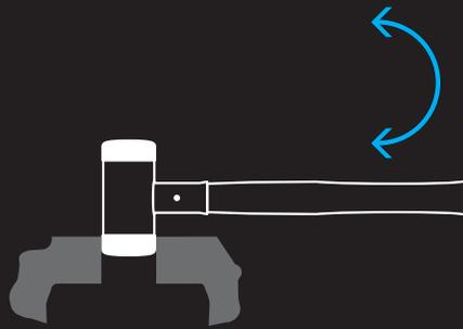
Abgenutzten Schlageinsatz im Schraubstock fest einspannen und den Schlageinsatz durch seitliches Verdrehen lockern.
