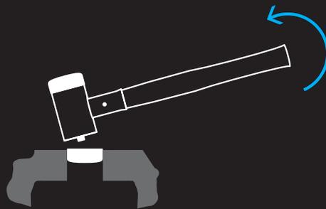
Nachdem der Schlageinsatz gelockert wurde, den Hammer nach oben abziehen.
