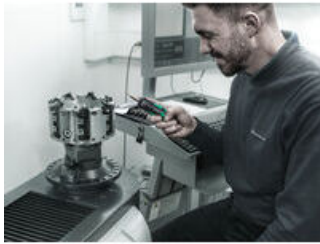
Drehmomentschraubendreher mit Schnelleinstellung
