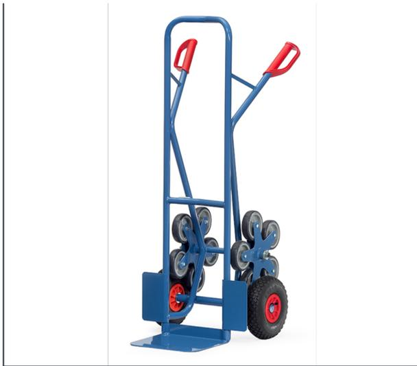
Stabile Schweißkonstruktion, mit Stahlblechschaufel, pulverbeschichtet, nur blau RAL 5007. Sicherheitsgriffe. Zerlegte Anlieferung. Mit 2 Lufträdern, Kunststoff-Felgen, Naben mit Rollenlagerung und 2 fünfarmigen Rad-Sternen, jeweils 5 TPE-Räder 125 mm Ø, Naben mit Gleitlager. Bügel oben und Querstreben durchgebogen. Für den sicheren Transport von runden Gütern, wie Rollen, Kannen, Eimern usw.
