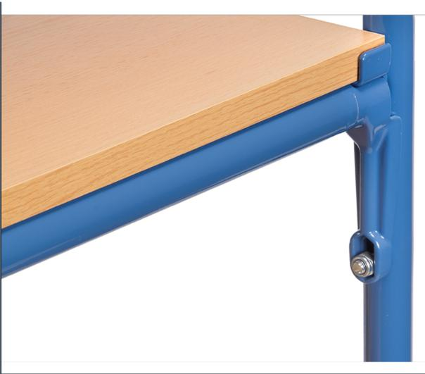
Diese Streben mit Flanschen und Zweipunkt-Verschraubung in brillantblau werden einfach unter einer vorhandenen Etage verschraubt. Das stabilisiert den Aufbau und erhöht die Tragkraft der Einlegeböden. Der Boden, der über den Versteifungsstreben liegt, trägt durch die Unterstützung 150 kg anstatt 90 kg. 1 Paar wird pro Etagenwagen mitgeliefert.
