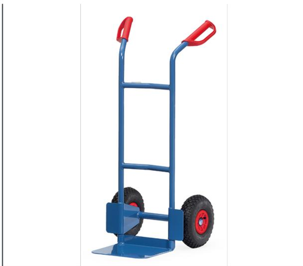
Handliche Stapelkarre mit Stahlblechschaufel, stabile Schweißkonstruktion, pulverbeschichtet blau RAL 5007. fetra Sicherheitsgriffe. Stahlblechschaufel anschraubbar und dadurch austauschbar. Räder mit Luftbereifung auf Kunststoff-Felgen, Naben mit Rollenlagerung. Bügel oben und Querstreben durchgebogen. Für den sicheren Transport von runden Gütern, wie Rollen, Kannen, Eimern usw. Zerlegte Anlieferung.
