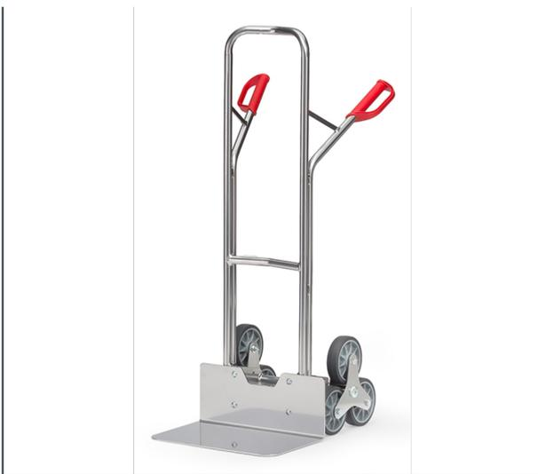
Aus Aluminiumrohr mit Aluminiumschaufel, handliche Schweißkonstruktion. Sicherheitsgriffe. Mit 2 dreiarmigen Rad-Sternen, jeweils 3 TPE-Räder 160 mm Ø, Naben mit Kugellager. Bügel oben und Querstreben durchgebogen. Für den sicheren Transport von runden Gütern, wie Rollen, Kannen, Eimern usw.
