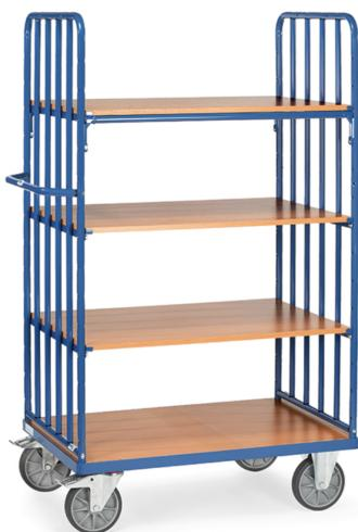
Baukasten-System: Aus Stahlrohr und Profilstahl geschweißt, pulverbeschichtet blau RAL 5007, Schraubkonstruktion. Stirnwände mit vertikalen Rohrstreben im Abstand von 130 mm. 1 fester und 3 lose Einlegeböden aus Holzwerkstoffplatten, Oberfläche Buchendekor. Einlegeböden variabel einsetzbar, Teilung 100 mm. Tragkraft pro Einlegeboden 90 kg. 2 Lenk- und 2 Bockrollen, TPE-Bereifung, Nabensicherung mit Rillenkugellager. Feststeller an den Lenkrollen.
