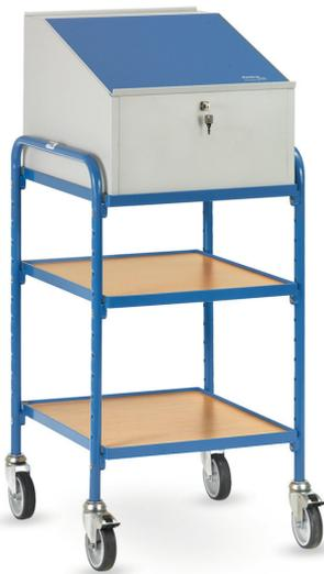
Rollpult aus Stahlrohr und Profilstahl geschweißt, Schraubkonstruktion, pulverbeschichtet, blau RAL 5007. Mit 1 Schreibpult aus Stahlblech, pulverbeschichtet lichtgrau RAL 7035. Schreibplatte aufklappbar und abschließbar. Mit aufgeklebter Schreibunterlage. 2 Ablageböden im Raster von 50 mm variabel einschraubbar. 1x Ordnerhöhe möglich. Tragkraft pro Boden 50 kg. 4 Lenkrollen mit TPE-Bereifung, Naben mit Gleitlager. 2 Stück mit Feststeller.
