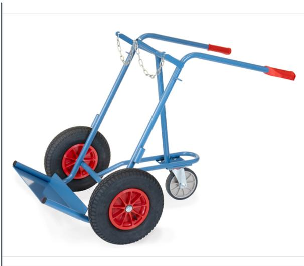
Stahlflaschenkarre aus Stahlrohr geschweißt, pulverbeschichtet blau RAL 5007. Flaschenhalterungen mit Kettensicherung. Räder mit Luftbereifung, Naben mit Rollenlager. Schweißdrahtköcher an beiden Holmen. Zusätzlich mit 1 Stütz-Lenkrolle aus TPE 200 x 40 mm.
