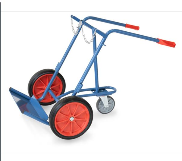
Stahlflaschenkarre aus Stahlrohr geschweißt, pulverbeschichtet blau RAL 5007. Flaschenhalterungen mit Kettensicherung. Räder mit Vollgummibereifung, Naben mit Rollenlager. Schweißdrahtköcher an beiden Holmen. Zusätzlich mit 1 Stütz-Lenkrolle aus TPE 200 x 40 mm.
