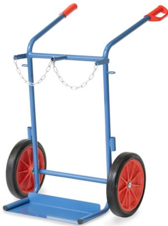
Stahlflaschenkarre aus Stahlrohr geschweißt, pulverbeschichtet blau RAL 5007. Flaschenhalterungen mit Kettensicherung. Räder mit Vollgummibereifung, Naben mit Rollenlager. Schweißdrahtköcher an beiden Holmen.
