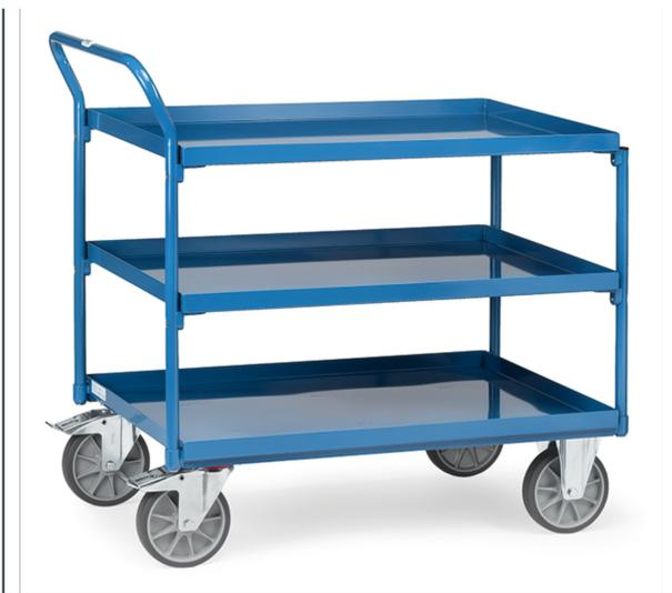
Tischwagen Stahlkonstruktion geschweißt. Mit 3 Stahlblechwannen. Stahlrohrbügel und Stahlblechwannen werden miteinander verschraubt. Wannen öldicht, Rand 40 mm hoch. Pulverbeschichtet brillantblau RAL 5007. Schiebegriff waagrecht. 2 Lenk- und 2 Bockrollen, TPE-Bereifung, Naben mit Rillenkugellager. Feststeller an den Lenkrollen. Tragkraft obere und mittlere Ladefläche 200 kg.
