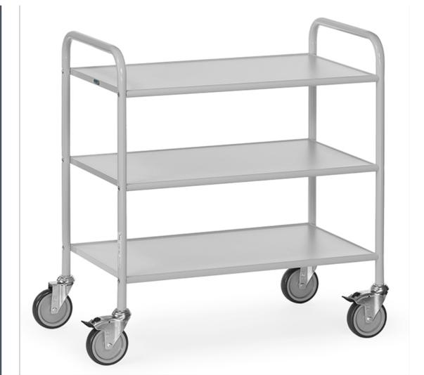
Baukasten-System: verschraubte Stahlrohr-Konstruktion, pulverbeschichtet in lichtgrau RAL 7035. 3 Böden aus Holzwerkstoffplatten, hellgrau. 4 Lenkrollen, Räder mit TPE-Bereifung, elastisch und leicht laufend, spurlos. Naben mit Gleitlager. 2 Lenkrollen mit Feststeller. Zerlegte Anlieferung, leichte Selbstmontage.
