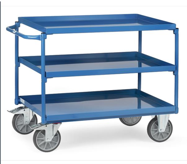
Tischwagen Stahlkonstruktion geschweißbt. Mit 3 öldichten Stahlblechwannen mit 40 mm hohen Rand. Stahlrohrrügel und Stahlblechwannen verschraubt. Pulverbeschichtet brillantblau RAL 5007. Schiebegriff waagrecht. 2 Lenk- und 2 Bockrollen, TPE-Bereifung, Naben mit Rillenkugellager. Feststeller an den Lenkrollen. Tragkraft obere und mittlere Ladefläche 200 kg.
