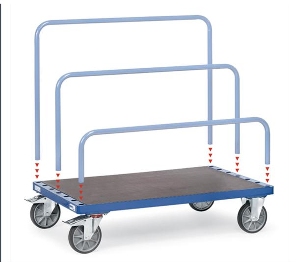
Profilstahl und Stahlrohr geschweißt, pulverbeschichtet, Holzplattform. 7 Verstellmöglichkeiten für Einsteckbügel. Bügelabstand licht 90 mm, 2 Lenk- und 2 Bockrollen, Lenkrollen mit Feststeller. TPE-Bereifung, Naben mit Rillenkugellager. Lieferung ohne Bügel.
