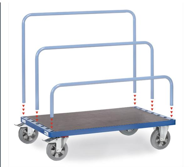
Profilstahl und Stahlrohr geschweißt, pulverbeschichtet, Holzplattform. 7 Verstellmöglichkeiten für Einsteckbügel. Bügelabstand licht 90 mm, 2 Lenk- und 2 Bockrollen, Lenkrollen mit Feststeller. Vollgummi-Elastic-Bereifung, blaugrau "spurlos", Naben mit Kugellager. Lieferung ohne Bügel.
