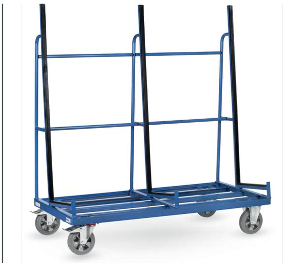
Baukasten-System: zum sicheren Transport von Glasscheiben, Holz- und Kunststoffplatten sowie kompletter Fenster und Türen. Profilstahl und Stahlrohr geschweißt. Pulverbeschichtet, blau RAL 5007. Einseitige Anlagen mit Profilgummi belegt. Auflagebreite 430 mm, Anlagehöhe 1450 mm. 2 Lenk- und 2 Bockrollen, Vollgummi-Elastic-Bereifung, blaugrau "spurlos", Naben mit Kugellager. Feststeller an den Lenkrollen.
