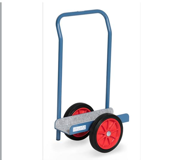
Stahlblech-Konstruktion, pulverbeschichtet blau RAL 5007, Innenflächen mit Filzbelag. mit Anlage- und Schiebebügel. Räder mit Vollgummibereifung. Lichte Breite 150 mm.
