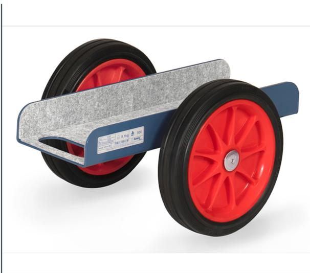
Stahlblech-Konstruktion, pulverbeschichtet blau RAL 5007, Innenflächen mit Filzbelag. Räder mit Vollgummibereifung. Lichte Breite 150 mm.
