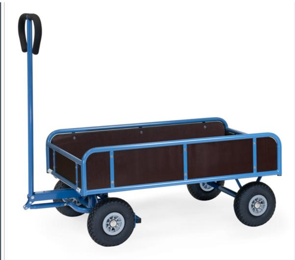
Aus Stahlrohr geschweißt, pulverbeschichtet brillantblau RAL 5007. Geländer 180/250 mm hoch, Ladefläche und Wände aus wasserfestem Sperrholz. Drehschemel-Lenkung mit Deichsel und Handgriff. Deichsel mit Sicherheitshandgriff mit Softgrip-Bezug und automatischer gedämpfter Rückstellung in Ruheposition. Räder mit Luftbereifung, Naben mit Rollenlager. Automatische Feststellbremse auf die Vorderräder wirkend.
