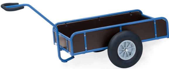
Handwagen aus Stahlrohr geschweißt, pulverbeschichtet, brillantblau RAL 5007. Anschraubbare Deichsel mit Sicherheitsgriff und hautsympathischem Softgrip-Bezug. Ladefläche aus wasserfestem Sperrholz. Mit 4 Wänden aus wasserfestem Sperrholz, 180/250 mm hoch. Räder mit Luftbereifung, Naben mit Rollenlager.
