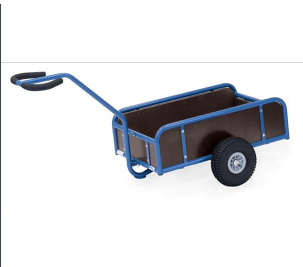
Handwagen aus Stahlrohr geschweißt, pulverbeschichtet, brillantblau RAL 5007. Anschraubbare Deichsel mit Sicherheitsgriff und hautsympathischem Softgrip-Bezug. Ladefläche aus wasserfestem Sperrholz. Mit 4 Wänden aus wasserfestem Sperrholz, 180/250 mm hoch. Räder mit Luftbereifung, Naben mit Rollenlager.
