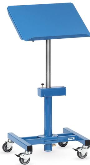
Für Kunststoffkästen, Stahlblechkästen, Drahtkörbe usw., höhenverstellbar und fahrbar. Profilstahl-/Rohrkonstruktion mit Stahlblechplattform. Plattform mit einseitiger Anlegekante, neigbar um 15° und 30°, stufenlos höhenverstellbar, dreh- und arretierbar, mit pneumatischer Absenkämpfung. Pulverbeschichtet blau RAL 5007. 4 Lenkrollen, Naben mit Gleitlagerung, 2 davon mit Feststeller. 3290: 510 - 700 mm höhenverstellbar 3291: 720 - 1070 mm höhenverstellbar
