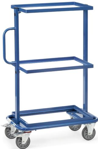
Beistellwagen aus Stahlrohr- und Profilstahl-Konstruktion, pulverbeschichtet, blau RAL 5007. Mit 3 offenen Rahmen passend für Eurokästen. 2 Lenk- und 2 Bockrollen, TPE-Bereifung, Naben mit Rillenkugellager. Feststeller an den Lenkrollen. Tragkraft obere und mittlere Ladefläche 50 kg.
