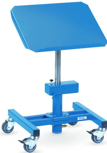
Für Kunststoffkästen, Stahlblechkästen, Drahtkörbe usw., höhenverstellbar und fahrbar. Profilstahl-/Rohrkonstruktion mit Stahlblechplattform. Plattform mit einseitiger Anlegekante, neigbar um 15° und 30°, stufenlos höhenverstellbar, dreh- und arretierbar, mit pneumatischer Absenkämpfung. Pulverbeschichtet blau RAL 5007. 4 Lenkrollen, Naben mit Gleitlagerung, 2 davon mit Feststeller. 3290: 510 - 700 mm höhenverstellbar 3291: 720 - 1070 mm höhenverstellbar
