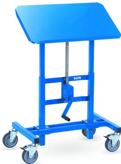
Für Kunststoffkästen, Stahlblechkästen, Drahtkörbe usw., höhenverstellbar und fahrbar. Profilstahl-/Rohrkonstruktion mit Stahlblechplattform. Plattform mit einseitiger Anlegekante, neigbar um 15° und 30°, stufenlos höhenverstellbar mittels Zahnstangenwinde, auch unter Last möglich. 2 Teleskopsäulen. Pulverbeschichtet blau RAL 5007. 4 Lenkrollen, Naben mit Gleitlagerung, 2 davon mit Feststeller.
