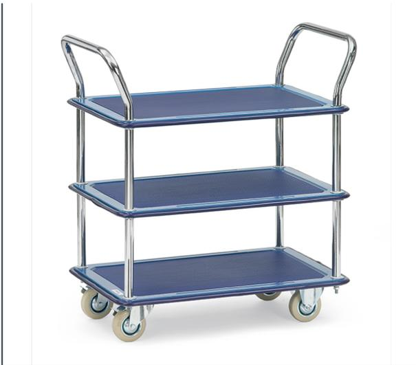
Tischwagen mit 3 Plattformen aus Stahlblech gepresst, pulverbeschichtet brillantblau RAL 5007. Mit aufgeklebtem Antirutschbelag und umlaufender Schutzleiste. Rohrschiebebügel feststehend, glanzverzinkt. 2 Lenk- und 2 Bockrollen, Vollgummi-Bereifung, Feststeller an den Lenkrollen. Zerlegte Anlieferung. Tragkraft obere und mittlere Ladefläche 60 kg.
