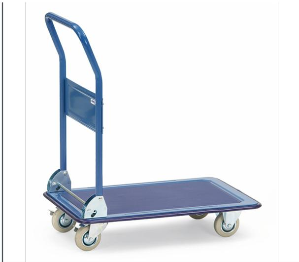
Ganzstahlwagen mit Plattform aus Stahlblech gepresst, pulverbeschichtet blau RAL 5007. Mit aufgeklebtem Antirutschbelag und umlaufender Schutzleiste. Rohrschiebebügel klappbar, mit breiter Querstrebe. Klappgelenk glanzverzinkt. 2 Lenk- und 2 Bockrollen, Vollgummibereifung, Feststeller an den Lenkrollen. Zerlegte Anlieferung.
