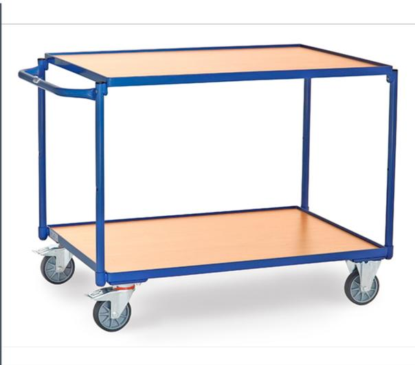
Leichter Tischwagen aus Stahlrohr und Profilstahl geschweißt, pulverbeschichtet brillantblau RAL 5007. Schraubkonstruktion. 2 Böden aus Holzwerkstoffplatte, Oberfläche Buchendekor, im Stahlrahmen liegend, Rand 12 mm hoch. Schiebegriff waagrecht. 2 Lenk- und 2 Bockrollen, TPE-Bereifung, Naben mit Rillenkugellager. Feststeller an den Lenkrollen. Tragkraft obere Ladefläche 80 kg.
