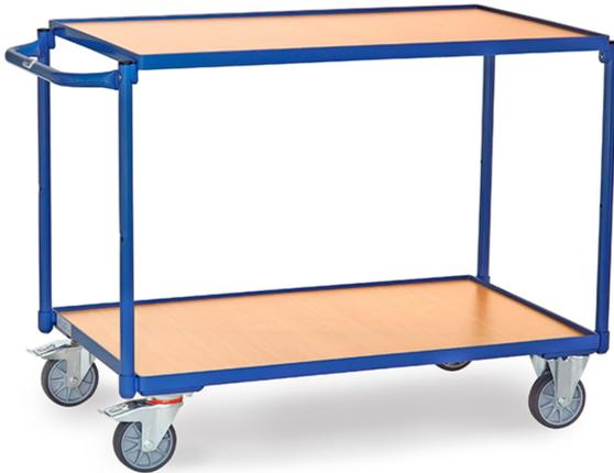
Leichter Tischwagen aus Stahlrohr und Profilstahl geschweißt, pulverbeschichtet brillantblau RAL 5007. Schraubkonstruktion. 2 Böden aus Holzwerkstoffplatte, Oberfläche Buchendekor, im Stahlrahmen liegend, Rand 12 mm hoch. Schiebegriff waagrecht. 2 Lenk- und 2 Bockrollen, TPE-Bereifung, Naben mit Rillenkugellager. Feststeller an den Lenkrollen. Tragkraft obere Ladefläche 80 kg.
