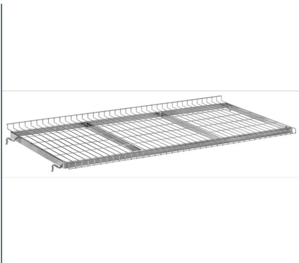
Etagenboden aus Drahtgitter mit Maschenweite 120 x 30 mm, galvanisch glanzverzinkt. An einer Längsseite 23 mm nach oben, an der anderen 23 mm unten abgekantet. Im Raster von 100 mm waagrecht oder geneigt einhängbar. Tragkraft pro Boden 80 kg
