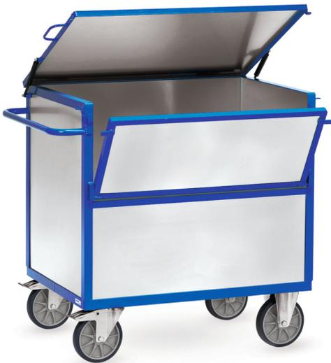
Stahlrohr und Profilstahl geschweißt, pulverbeschichtet blau RAL 5007. Boden aus Stahlblech, pulverbeschichtet. Winkelstahl-Konstruktion. Wände aus verzinktem Stahlblech, eingeklebt. Mit einteiligem Deckel, Hochstellung durch Gasdruckfedern. Ringösen für Vorhängeschlösser. 2 Lenk- und 2 Bockrollen, TPE-Bereifung, 200 x 40 mm, Naben mit Rillenkugellager. Feststeller an den Lenkrollen. Nutzhöhe: 816 mm.
