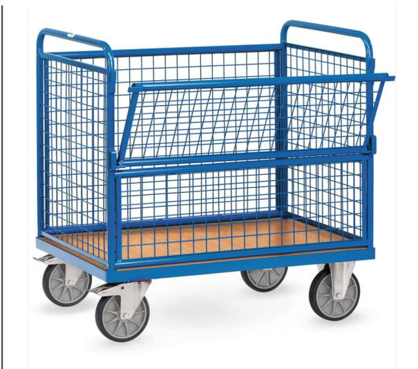
Stahlrohr und Profilstahl geschweißt, pulverbeschichtet blau RAL 5007. Boden aus Holzwerkstoffplatte, Oberfläche Buchendekor. Verschraubte Baukasten-Ausführung: Mit Stahlrohr-Aufbau, Drahtgitter 50 x 50 x 4 mm eingeschweißt 2 Lenk- und 2 Bockrollen, TPE-Bereifung, Naben mit Rillenkugellager. Feststeller an den Lenkrollen. Zerlegte Anlieferung. Nutzhöhe: 700 mm.
