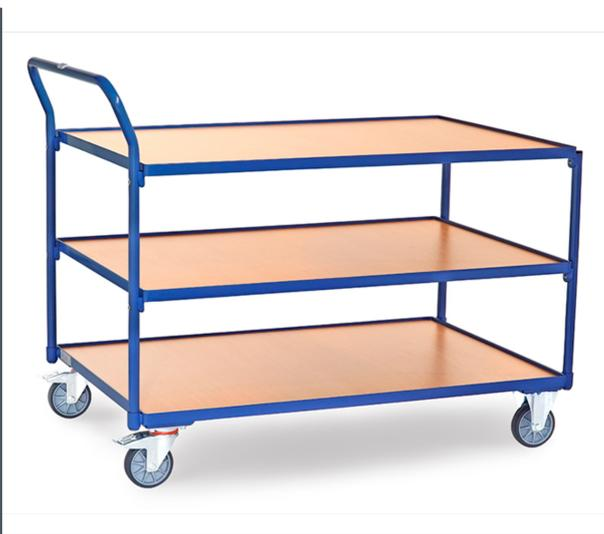
Leichter Tischwagen aus Stahlrohr und Profilstahl geschweißt, pulverbeschichtet brillantblau RAL 5007. Schraubkonstruktion. 3 Böden aus Holzwerkstoffplatte, Oberfläche Buchendekor, im Stahlrahmen liegend mit 12 mm hohen Rand. Schiebegriff hochstehend. 2 Lenk- und 2 Bockrollen, TPE-Bereifung, Naben mit Rillenkugellager. Feststeller an den Lenkrollen. Tragkraft obere und mittlere Ladefläche 80 kg.
