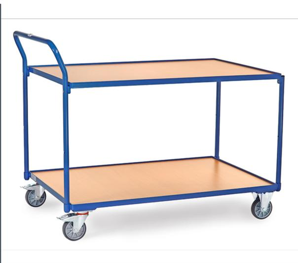
Leichter Tischwagen im Baukasten-System. Stahlrohr und Profilstahl geschweißt, pulverbeschichtet. Schraubkonstruktion. 2 Böden aus Holzwerkstoffplatte, Oberfläche Buchendekor, im Stahlrahmen liegend, Rand 12 mm hoch. Schiebegriff hochstehend. 2 Lenk- und 2 Bockrollen, TPE-Bereifung, Naben mit Rillenkugellager. Feststeller an den Lenkrollen. Tragkraft obere Ladefläche 80 kg.
