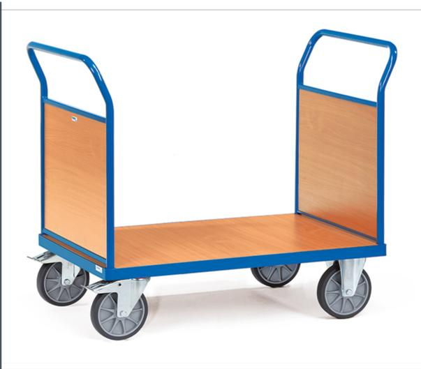
Stahlrohr und Profilstahl geschweißt, pulverbeschichtet RAL 5007, Plattform Holzwerkstoffplatte, Oberfläche Buchendekor. 2 Stirnwände aus Holzwerkstoffplatte, Oberfläche Buchendekor, Wände 500 mm hoch. 2 Lenk- und 2 Bockrollen, TPE-Bereifung, Naben mit Rillenkugellager. Feststeller an den Lenkrollen.
