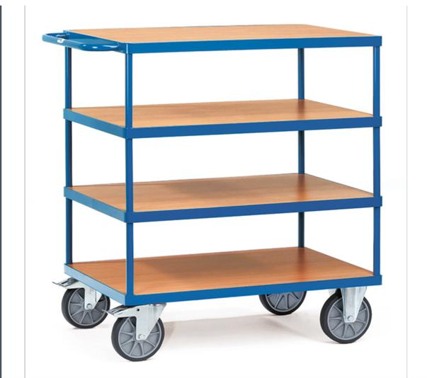
Stahlrohr und Profilstahl geschweißt, pulverbeschichtet RAL 5007. 4 Plattformen aus Holzwerkstoffplatte, Oberfläche Buchendekor. 2 Lenk- und 2 Bockrollen, TPE-Bereifung, Naben mit Rillenkugellager. Feststeller an den Lenkrollen.
