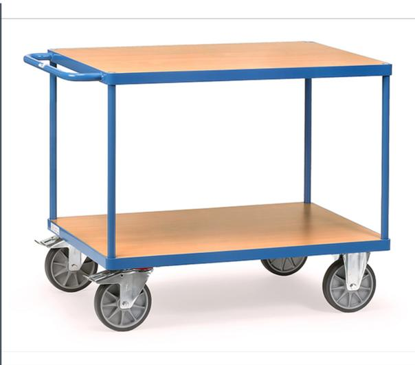
Tischwagen mit dem MultiVario Baukasten-System aus Stahlrohr und Profilstahl geschweißt, pulverbeschichtet blau RAL 5007. Dauerhaft oberflächengeschützt, schlag- und kratzfest. 2 Plattformen aus Holzwerkstoffplatte, Oberfläche Buchendekor. Die Systemteile werden einfach eingesteckt und festgeschraubt. 2 Lenk- und 2 Bockrollen mit TPE-Bereifung und Naben mit Rillenkugellager. Feststeller an den Lenkrollen. Tragkraft obere Ladefläche 200 kg.
