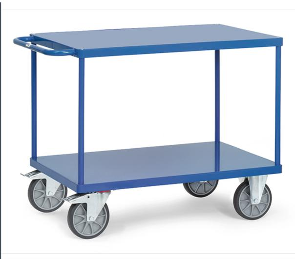
Stahlrohr und Profilstahl geschweißt, pulverbeschichtet RAL 5007. 2 Plattformen aus Stahlblech, bündig im Rahmen, sauber eingeschweißt, ebenfalls pulverbeschichtet RAL 5007. 2 Lenk- und 2 Bockrollen, TPE-Bereifung, Naben mit Rillenkugellager. Feststeller an den Lenkrollen. Tragkraft obere Ladefläche 200 kg.
