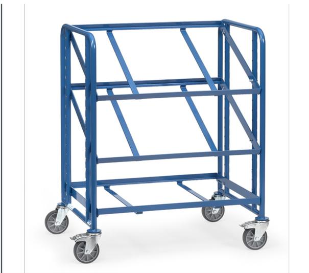
Stahlrohr und Profilstahl-Konstruktion, pulverbeschichtet RAL 5007. Schraubkonstruktion. Etagenrahmen variabel einschraubbar, Raster 50 mm, Neigung bei schrägem Einbau 15° oder 30°. Tragkraft obere und mittlere Ladefläche 80 kg. 3 Etagenrahmen passend für je 1 Eurokasten. 4 Lenkrollen, TPE-Bereifung, Naben mit Rillenkugellager. 2 Stück mit Feststeller.
