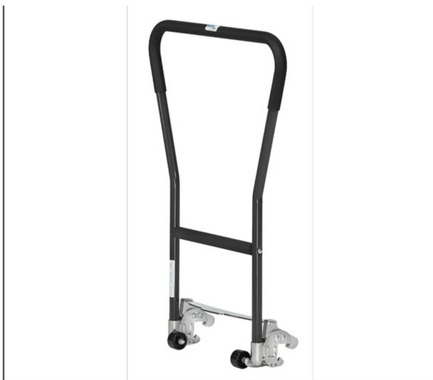
Der Einklink-Rohrschiebebügel kann als Schiebebügel für fetra Paletten-Fahrgestelle genutzt werden. Zum bequemen rückschonenden Verfahren von leeren und beladenen Paletten-Fahrgestellen. Äußerst robuste Stahlrohr-Konstruktion mit kräftigen Verbindungsklauen. Bügel und Querbügel mit Softgrip-Bezug. Im ausgeklipkten Zustand mittels 2 Hilfsrollen kräfteschonend verfahrbar. Nicht für das leichte Paletten-Fahrgestell und die Paletten-Fahrgestelle mit Ladeflächenabmessung 810 x 610 mm geeignet.
