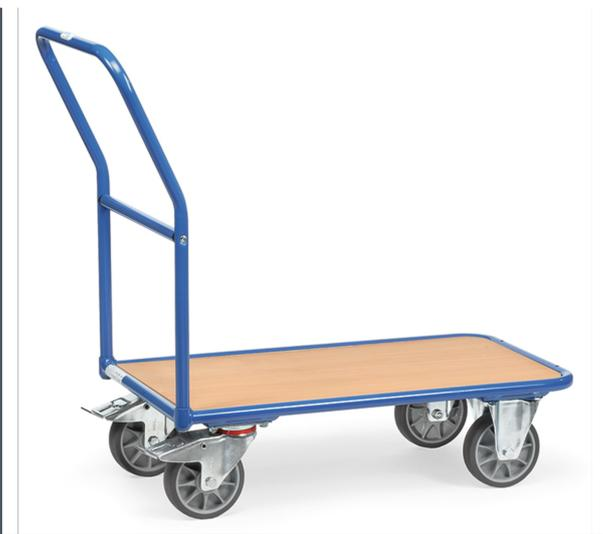
Transportwagen aus Stahlrohr, Schweißkonstruktion, pulverbeschichtet brillantblau RAL 5007. Plattform aus Holzwerkstoffplatte mit Oberfläche Buchendekor. 2 Lenk- und 2 Bockrollen mit TPE-Bereifung und Naben mit Rillenkugellager. Feststeller an den Lenkrollen.
