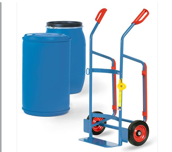
Fasskarre für den Transport von Kunststoff-Fässern mit 120-220 Liter Inhalt. Stahlrohr geschweißt, pulverbeschichtet, blau RAL 5007, dauerhaft oberflächengeschützt. Räder mit Vollgummibereifung, Naben mit Rollenlager. Spanngurt zur Fass-Sicherung.
