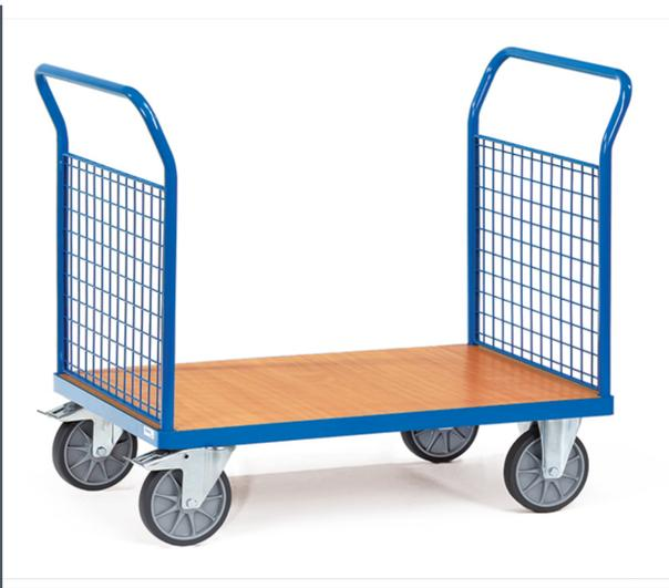
Stahlrohr und Profilstahl geschweißt, pulverbeschichtet RAL 5007, Plattform Holzwerkstoffplatte, Oberfläche Buchendekor. 2 Stirnwände aus Drahtgitter 50 x 50 x 4 mm, Wände 500 mm hoch. 2 Lenk- und 2 Bockrollen, TPE-Bereifung, Naben mit Rillenkugellager. Feststeller an den Lenkrollen.
