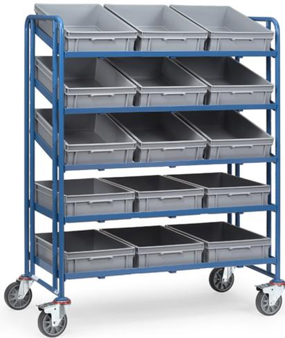
Eurokastenwagen im Baukasten-System: Stahlrohr und Profilstahl geschweißt, pulverbeschichtet blau RAL 5007, Schraubkonstruktion. Variabel einschraubbare Etagen, Raster 100 mm, Neigung bei schrägem Einbau 15° oder 30°. Tragkraft pro Ladefläche 80 kg. 5 Etagenrahmen mit 15 Eurokästen 600 x 400 x 145 mm. 4 Lenkrollen, TPE-Bereifung, Naben mit Rillenkugellager. 2 Stück mit Feststeller.
