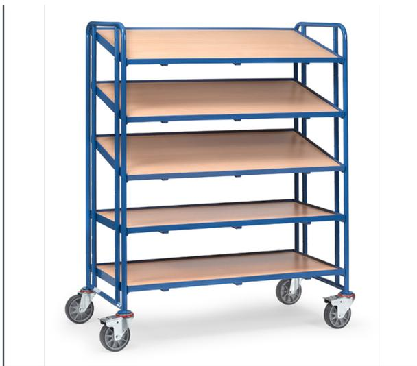
Eurokastenwagen im Baukasten-System: Stahlrohr und Profilstahl geschweißt, pulverbeschichtet blau RAL 5007, Schraubkonstruktion. Variabel einschraubbare Etagen im Raster von 100 mm möglich. Neigung bei schrägem Einbau 15° oder 30°. Tragkraft pro Ladefläche 80 kg. 5 Etagenrahmen passend für je 3 Eurokästen 600x400 mm. 4 Lenkrollen mit TPE-Bereifung und Naben mit Rillenkugellager. 2 Stück mit Feststeller.
