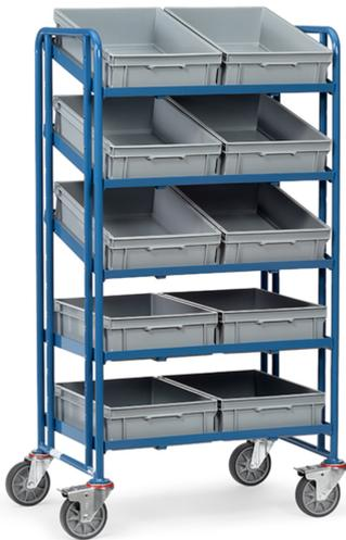
Eurokastenwagen im Baukasten-System: Stahlrohr und Profilstahl geschweißt, pulverbeschichtet blau RAL 5007, Schraubkonstruktion. Variabel einschraubbare Etagen, Raster 100 mm, Neigung bei schrägem Einbau 15° oder 30°. Tragkraft pro Ladefläche 80 kg. 5 Etagenrahmen mit 10 Eurokästen 600 x 400 x 145 mm. 4 Lenkrollen, TPE-Bereifung, Naben mit Rillenkugellager. 2 Stück mit Feststeller.
