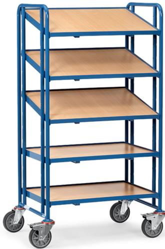
Eurokastenwagen im Baukasten-System: Stahlrohr und Profilstahl geschweißt, pulverbeschichtet blau RAL 5007, Schraubkonstruktion. Variabel einschraubbare Etagen im Raster von 100 mm, Neigung bei schrägem Einbau 15° oder 30°. Tragkraft pro Ladefläche 80 kg. 5 Etagenrahmen passend für 10 Eurokästen 600 x 400 mm. 4 Lenkrollen, TPE-Bereifung, Naben mit Rillenkugellager. 2 Stück mit Feststeller.
