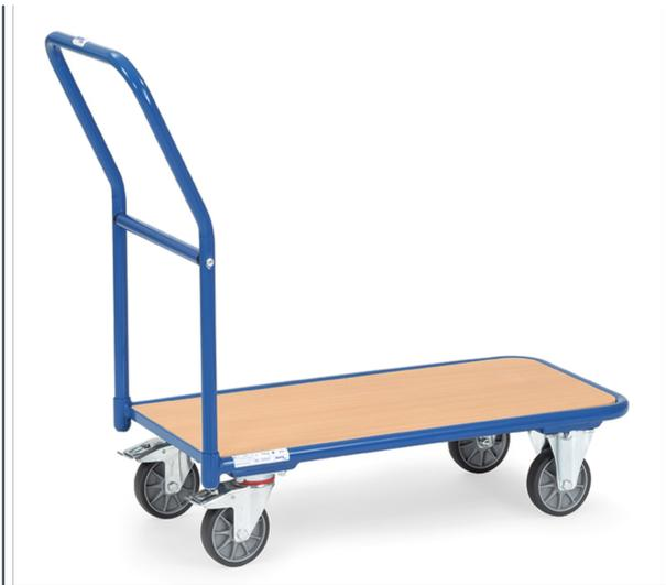
Stahlrohr, Schweißkonstruktion, pulverbeschichtet, blau RAL 5007. Plattform Holzwerkstoffplatte, Oberfläche Buchendekor. 2 Lenk- und 2 Bockrollen, TPE-Bereifung, Naben mit Rillenkugellager. Feststeller an den Lenkrollen.
